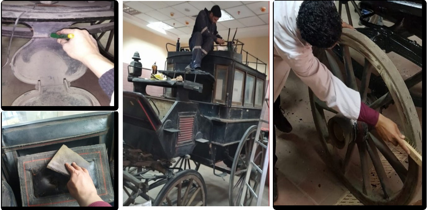
صورة ٨: مراحل التنظيف الميكانيكي لبدن العربة باستخدام الفرش الناعمة والأسفنج (© المؤلفون)
