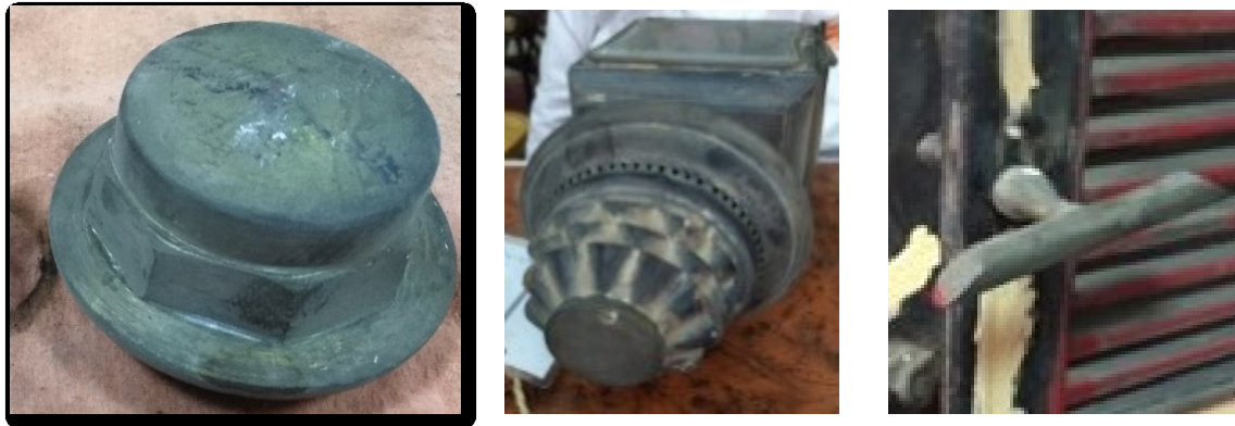
صورة ٤ج: توضح طبقات الصدأ بالأجزاء المعدنية (الفوانيس والسرر المعدنية للعجل) (© المؤلفون)
