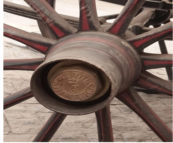
صورة ٣: التركيب التشريحي للعجلة وطرق التجميع بين محور العجلة والبرانق والإطار الداخلى والخارجى للعجلة (© المؤلفون)
