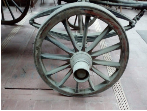
صورة ٣: التركيب التشريحي للعجلة وطرق التجميع بين محور العجلة والبرانق والإطار الداخلى والخارجى للعجلة (© المؤلفون)
